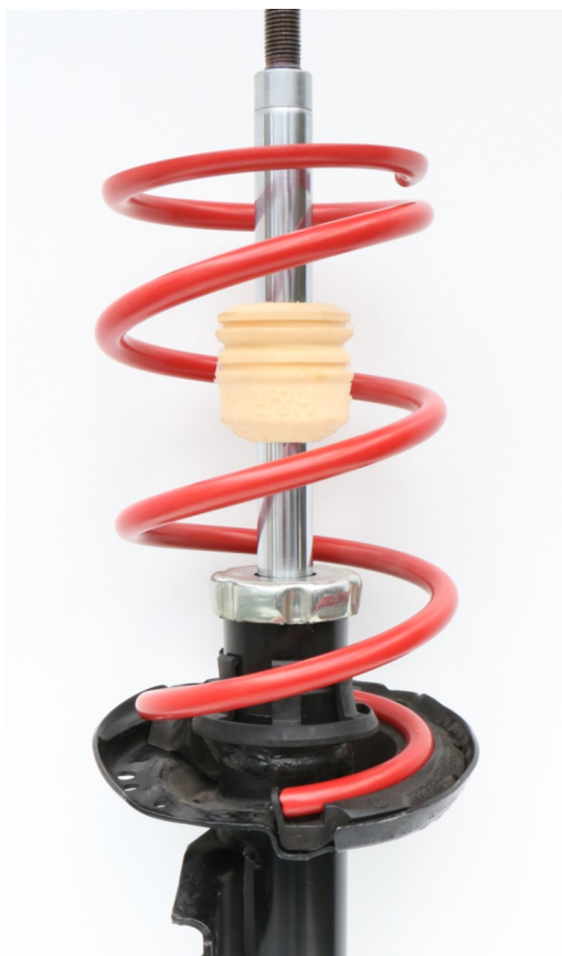
Abb. 2: Feder und Anschlagpuffer montieren
