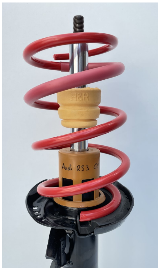
Abb. 2: Feder und Anschlagpuffer montieren
